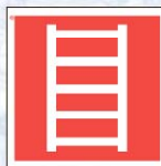
F03 Пожарная лестница
