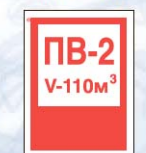
F31* Пожарный водосточник
