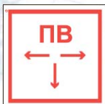
F40 Пожарный водосточник
