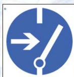
M14 Отключить перед работой
