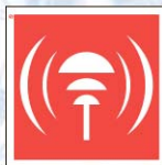
F12-01 Пункт извещения о пожаре
