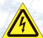
W08 Опасность поражения электрическим током
