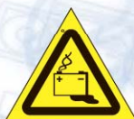
W20 Осторожно. Аккумуляторные батареи
