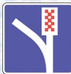
6.5 Полоса для аварийной остановки
